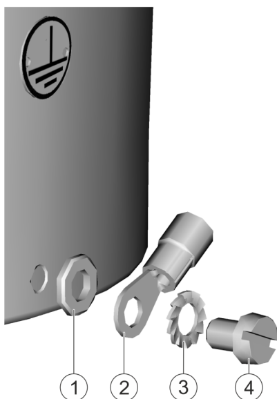
Obr. 6: Montáž uzemňovacího lanka
